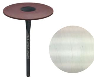
Im zweiten Schritt wird die gewünschte Restrauigkeit eingestellt. Die Panther edition Linse Smooth (lila) erzielt eine mittlere Rauigkeit von zirka 0,34  $\mu\text{m}$ . Das entspricht der geforderten Oberflächentopographie.
