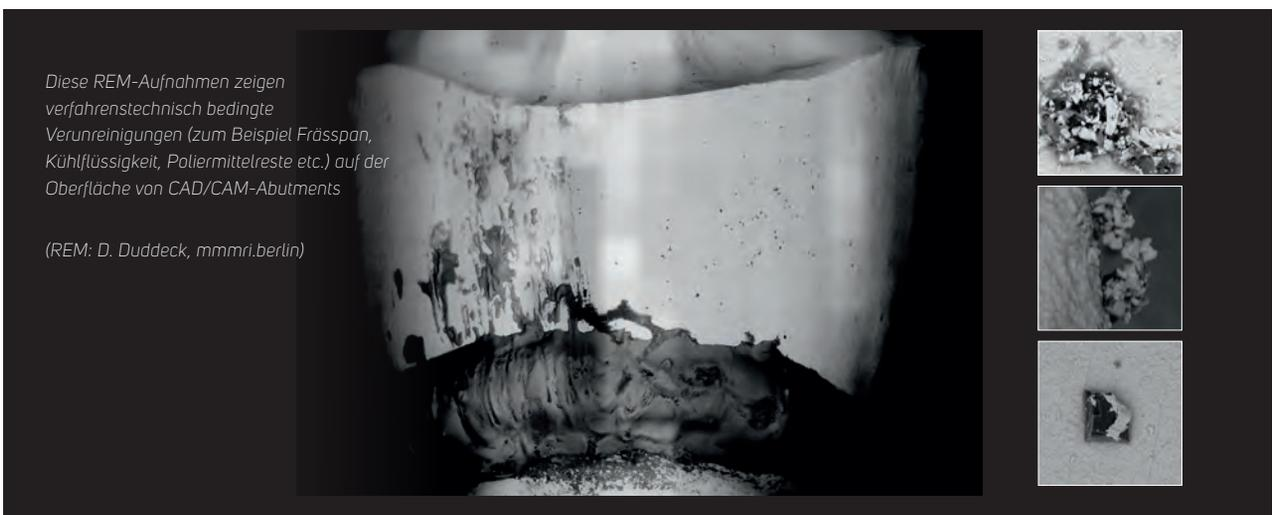
Das **Panther-Set by ARGEN** ermöglicht Zahn Technikern in einem zweistufigen Prozess die Entfernung von Verunreinigungspartikeln und ein kontrolliertes Erarbeiten des geforderten mittleren Oberflächen-Rauwerts der Zirkonoxid-Oberfläche.
